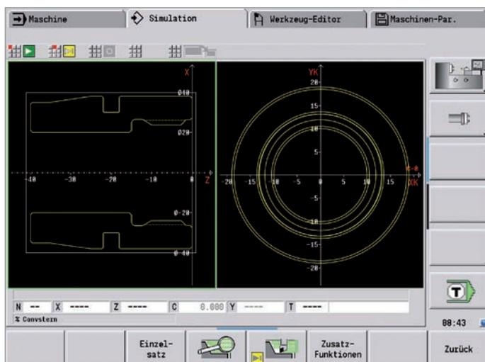
Grafische Konturprogrammierung für C-Achs-Bearbeitung (Bohren und Fräsen)
