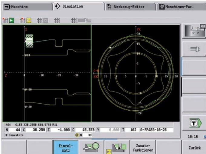
Rückseitenbearbeitung an der Gegenspindel nach automatischer Werkstückübergabe
