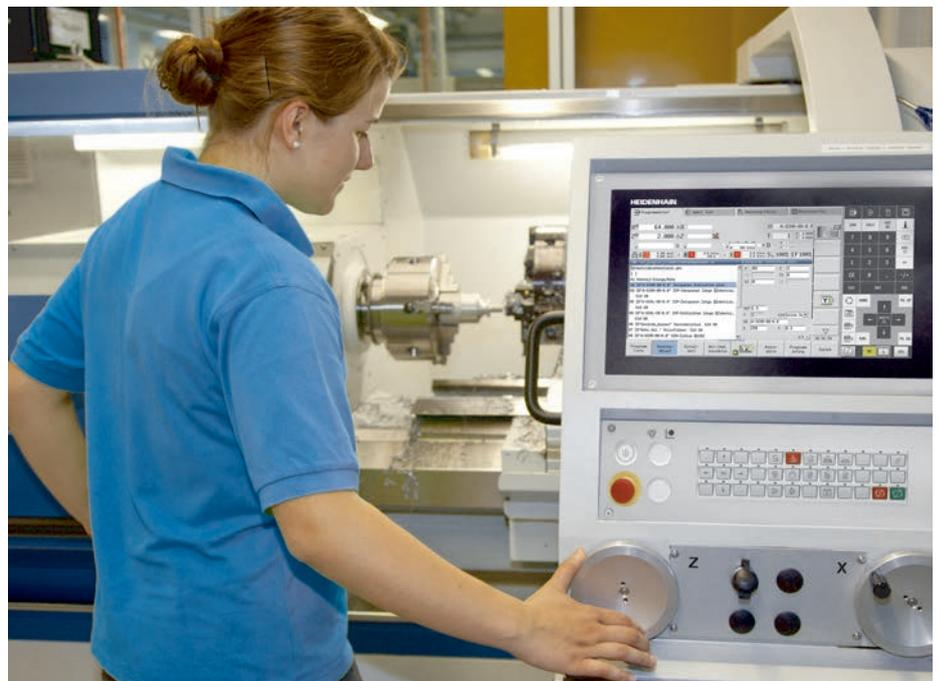
MANUALplus 620 an Zyklen-Drehmaschine
